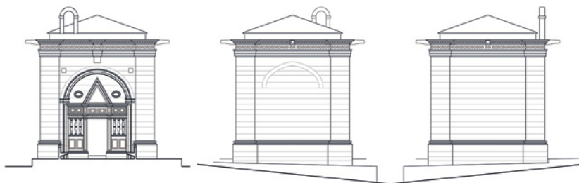
Fig. 19. Torre de Don Miguel, Ermita del Cristo, fachadas, norte, sur y este/oeste
