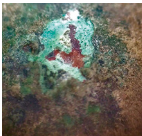
Fig. 2. Detalle de un cráter en una de las cuentas, visto a través de binocular. Se aprecia la cuprita en la zona más interna, rodeada por un depósito de malaquita y azurita. En una zona más superficial se puede distinguir una pátina de una tonalidad verde oscura, bajo una capa de suciedad (marrón), así como algunas zonas de tenorita (negro) (B. Sanmartín Freitas, Proyecto/Projet Albalat, 2021).
